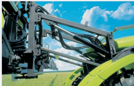
Zawieszanie belki na równoległoboku z amortyzacją hydrauliczno-gazową
