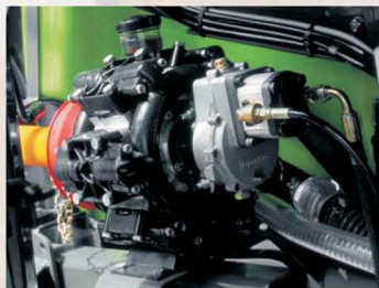
Pompa PM 500 zintegrowana z pompą hydrauliczną
