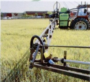
Откидные крайние секции на штанге 24/12 м HLE
