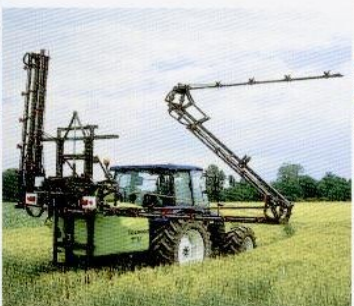
Раскладывание/складывание на штанге GDM
