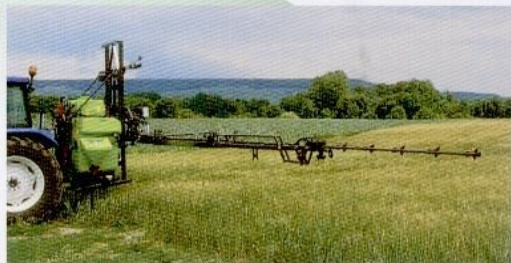
Штанга GDM 18 м. при опрыскивании
