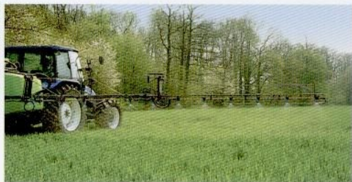
Штанга GC 15 м. при опрыскивании
