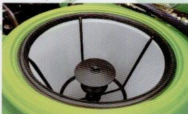
Грибовидная мешалка, встроенная в сетчатый фильтр
