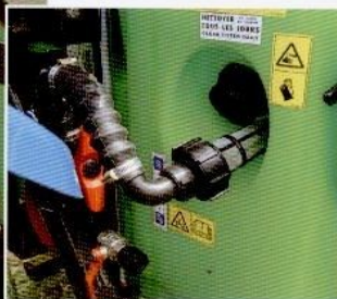
Главный фильтр и предохранительный клапан
